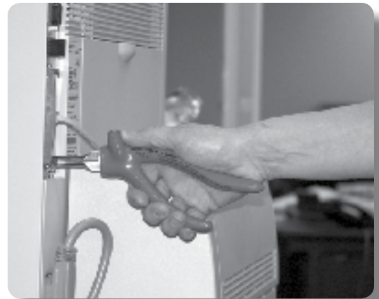
Los mangos curvos pueden ayudar a mantener la muñeca en posición recta
